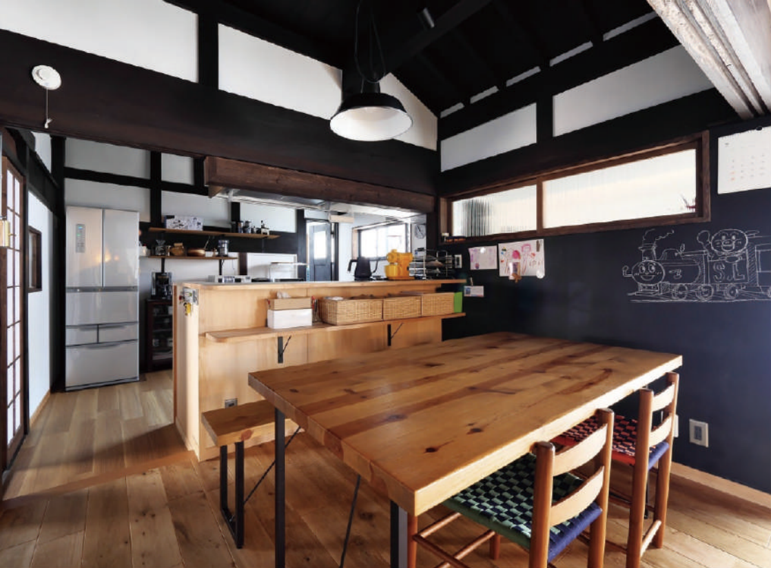
広々キッチンスペース。贅沢な空間の使い方ができるのも戸建てならではの。シナベニヤ貼の造作キッチンカウンターなど、あえて新しい素材を取り入れることで、古さがグッと際立ちます。黒板の壁はマグネット塗料と黒板塗料の重ね塗り。
